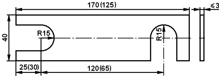
ნახ. 4.14. ღიანდაგის სარეგულირებელი შუასადები (ზომები ფრჩხილებს გარეთ – მუშა საწევისათვის, ფრჩხილებში – საკონტროლო საწევისათვის)
